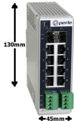
L'IDS-710HP est un commutateur Ethernet administrable à 10 ports qui peut fonctionner dans des environnements industriels, fournissant une performance avancée et permettant un fonctionnement déterministe en temps réel du réseau. Huit ports Ethernet 10/100/1000-Base-T sont disponibles pour la mise en réseau de dispositifs Gigabit et Fast Ethernet. Les deux ports SFP prennent en charge le 10/100/1000 pour le cuivre ou le 1G/2.5G pour la fibre.
